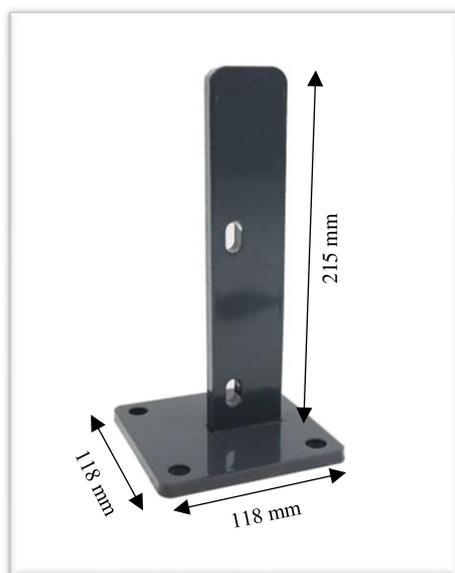
La platine permet la fixation du poteau à encoches sur une terrasse, un muret, une dalle béton. Il suffit d'insérer la platine dans le poteau à encoches, mettre les 2 vis pour un meilleur maintien de la platine dans le poteau (poteau et platine pré-perçés) et terminer par fixer le tout sur le support souhaité avec 4 chevilles.
