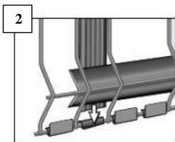
2 Placer les V de renfort dans les plis du panneau, puis insérer les 2 lamelles d'extrémités.
