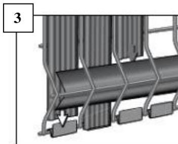
3 Insérer les lattes intermédiaires en les bloquant en partie basse sur les clips.
