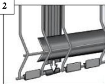
2 Placer les V de renfort dans les plis du panneau, puis insérer les 2 lamelles d'extrémités.
