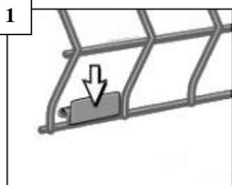
1 Placer les clips sur le fil horizontal du bas du panneau dans le sens indiqué.
