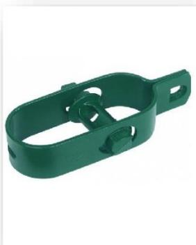
Les tendeurs permettent de tendre le fil de tension et ainsi assurer une meilleure rigidité de la clôture. Ils sont à positionner au départ, à la fin et aux angles de la clôture sur chaque rang de fil de tension.
