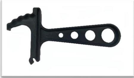
La cale de montage facilite la pose de la clôture. Elle permet la tension entre le panneau et le poteau pendant le scellement. Une fois le béton bien sec, les cales de montage peuvent être retirées et réutilisées.
