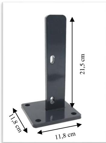
La platine PRO permet la fixation du poteau à encoches PRO sur une terrasse, un muret, une dalle béton. Il suffit d'insérer la platine dans le poteau à encoches, mettre les 2 vis pour un meilleur maintien de la platine dans le poteau (poteau et platine pré-percés) et terminer par fixer le tout sur le support souhaité avec 4 chevilles.
