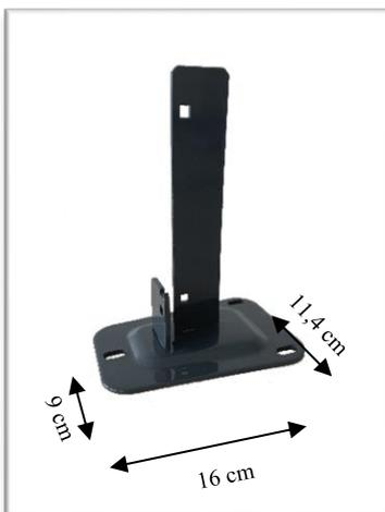
La platine STANDARD permet la fixation du poteau à encoches H STANDARD sur une terrasse, un muret, une dalle béton. Il suffit d'insérer la platine dans le poteau à encoches, mettre les 2 vis pour un meilleur maintien de la platine dans le poteau (poteau et platine pré-percés) et terminer par fixer le tout sur le support souhaité avec 3 chevilles.
