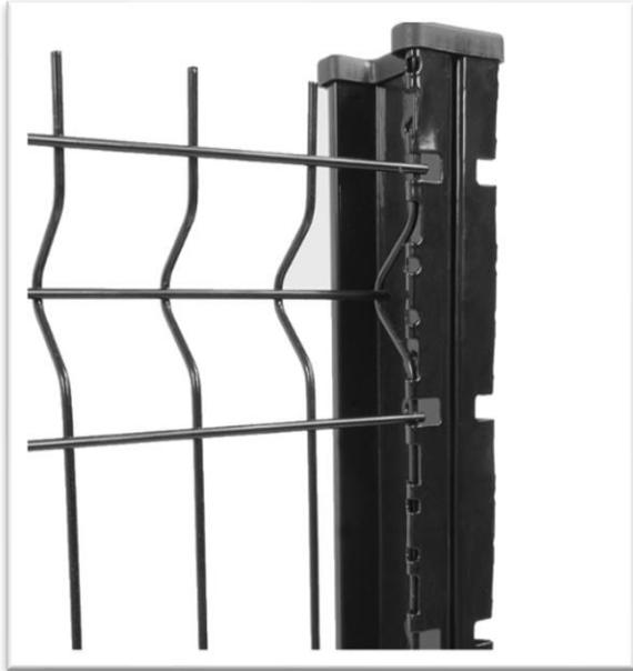
Le panneau rigide vient s'accrocher sur les encoches du poteau. Les cales de pose permettent de maintenir le panneau dans les encoches le temps de la pose.
