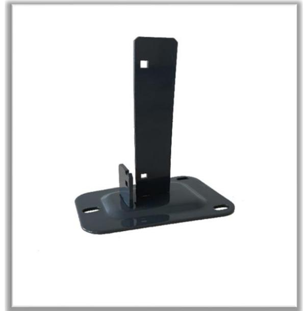
Pour une pose sur un muret, sur une terrasse, sur une dalle béton, le poteau peut être intégré à une platine et fixé avec 3 goujons d'ancrage Ø8.
